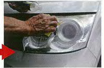
スピード液を塗り込み、その後拭き取ります。
