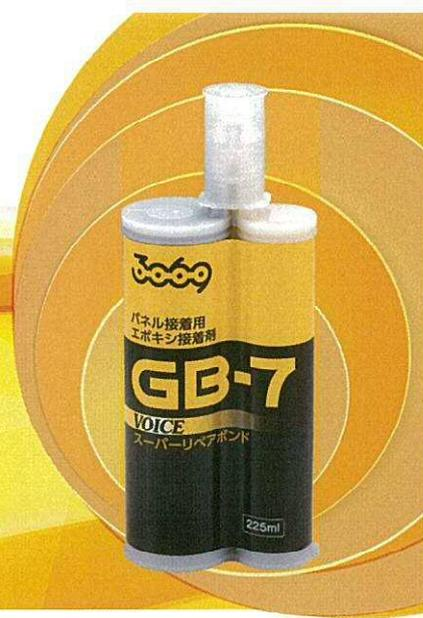
GB-7は外板(鉄板・アルミボディ)・FRP・カーボンパーツの接着用の高性能[1:1、2:1]液混合変性エポキシ系接着剤です。ルーフパネル・ドアアウターパネル・サイドパネル・クォーターパネル等の接着固定用として開発されました。\*注: コアサポートなどの構造部位には使用できません。特に補修箇所には注意してください。
